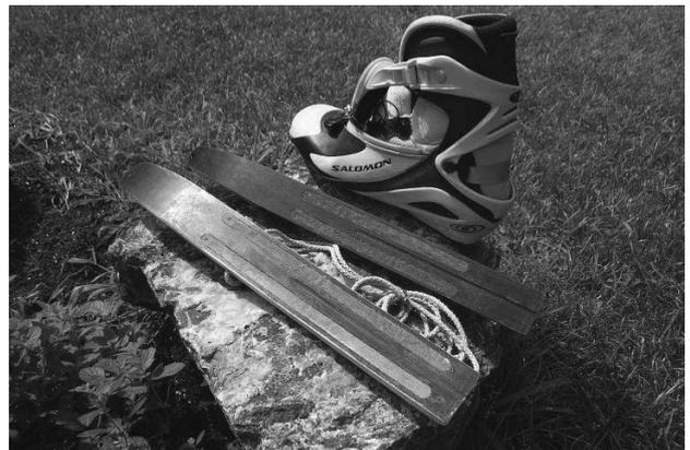
写真3 鮫鱗皮シール貼付の試験用スキー板 (滑走面)
